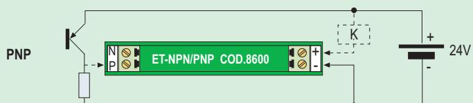
FUNZIONAMENTO: con +24V sul morsetto "P" si eccita il relè "K"
