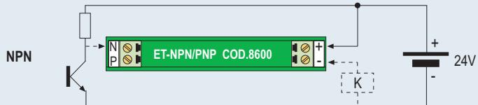
FUNZIONAMENTO: con 0V sul morsetto "N" si eccita il relè "K"
