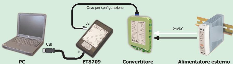
**CONNESSIONE "B":** la tensione di alimentazione al convertitore da configurare è fornita da un'alimentatore esterno collegato tramite l'interfaccia di configurazione ET8709.
