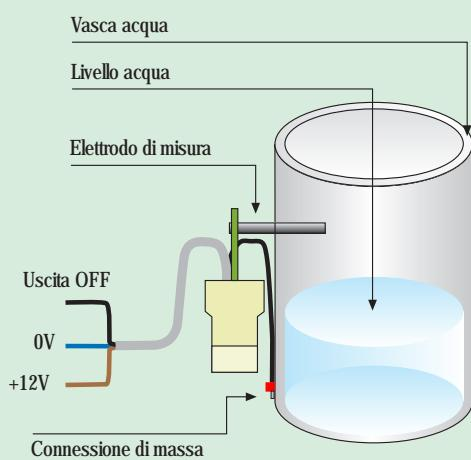
Quando il livello dell'acqua all'interno della vasca lambisce l'elettrodo di misura della sonda l'uscita si porta nello stato ON.
