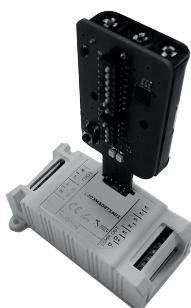
► **ETL392MA00N0A01** è un'interfaccia di programmazione parametri per i dimmer della famiglia ETL4xx ed in particolare è compatibile con i Dimmer:
